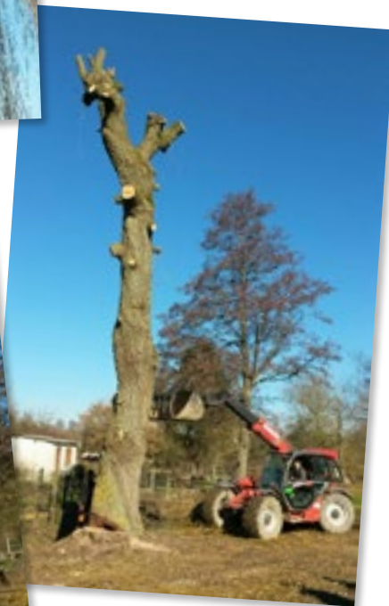
Un engin de levage, type "Manitou", a été positionné le long du tronc, à l'opposé de l'entaille, en protection. Sa pelle va aider la chute du tronc.
